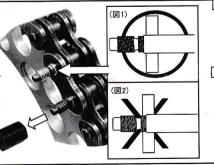
⑭外プレートが圧入された状態を再度確認後、ナットを(図3)の状態 まで戻し、ナットをプライヤー等で掴み、突き出ているピン2本を折 れば作業は完了です
