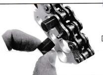
(12)スパナ(10mm)等を使用しナッ トを左右交互に60度ずつ締め、 外プレートを圧入します。 ナットが完全に廻らなくなるまで 締めて下さい。(必ず手作業で 行って下さい) 注)廻らなくなるまでと有りますが、 過大な力をかけ過ぎるとネジ部 が破損しナットが取れなくなる
